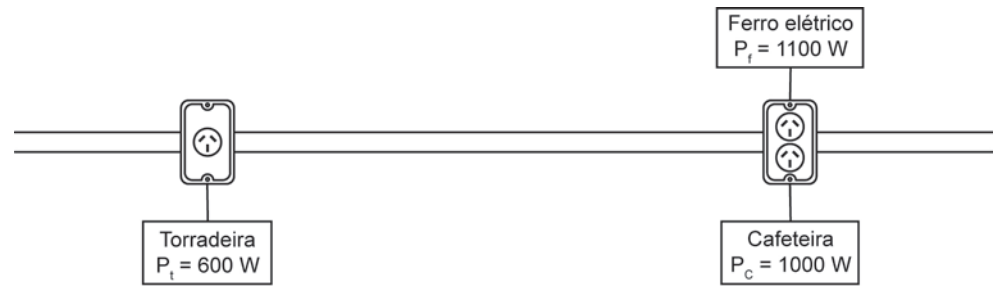
Figura 13 Tomadas de energia na prática.
