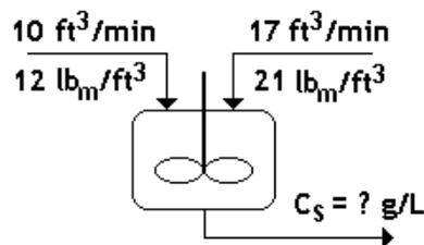
Figura 30 Tanque perfeitamente agitado para mistura de soluções.
