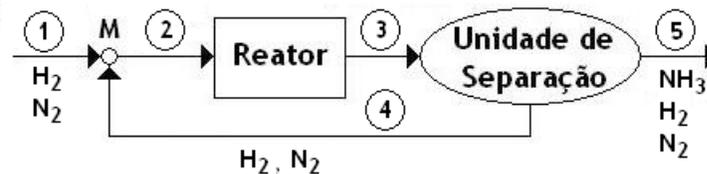
Figura 28 Fluxograma do processo de produção de amônia.
