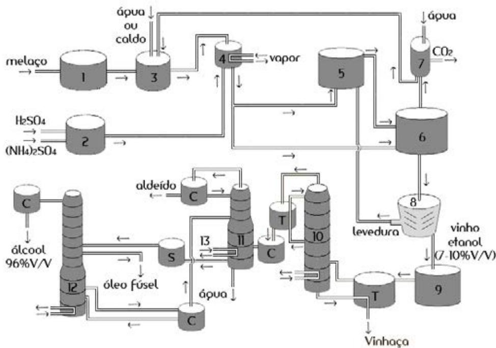
**Figura 2** Fluxograma de produção de etanol. (1) tanque de pesagem, (2) tanque de mistura de nutrientes, (3) tanque de preparação do mosto, (4) tanque de esterilização do mosto, (5) tanque de tratamento de levedura, (6) dorna de fermentação, (7) coluna de lavagem de  $CO_2$ , (8) centrífuga, (9) dorna volante, (10) coluna de destilação, (11) coluna de purificação, (12) coluna de retificação, (13) vapor de água, (T) trocador de calor, (C) condensador, (S) separador.
