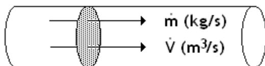
**Figura 3** Escoamento de um fluido em tubulação.
