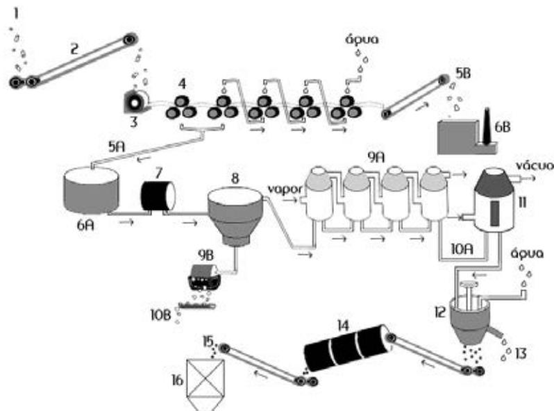
**Figura 1** Fluxograma de produção de açúcar. (1) recebimento da cana, (2) transportador, (3) triturador, (4) moenda, (5A) caldo de cana, (5B) bagaço, (6A) tanque de decantação, (6B) caldeira, (7) aquecedor, (8) tanque de clarificação, (9A) evaporador a vácuo, (9B) filtro rotativo, (10A) caldo concentrado, (10B) torta de filtro, (11) cristalizador, (12) centrífuga, (13) melaço, (14) secador, (15) açúcar seco, (16) silo de estoque.
