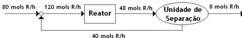
**Figura 23** Fluxograma de um processo com reação.
