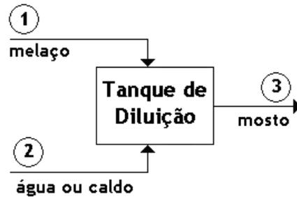
**Figura 25** Fluxograma de um processo de diluição.
