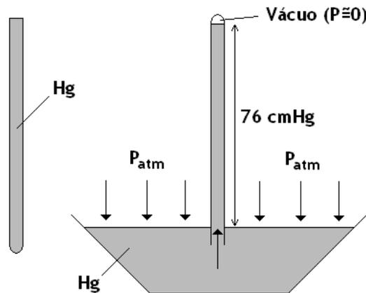
**Figura 6** Determinação da pressão atmosférica – Experimento de Torricelli.
