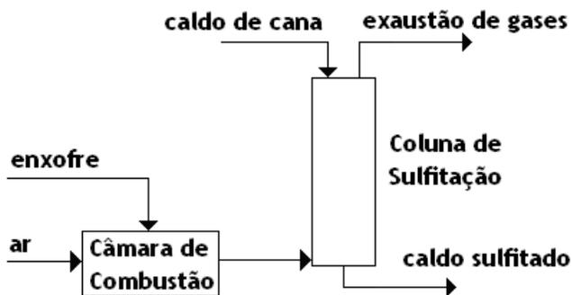
Figura 27 Fluxograma de um processo de sulfitação.
