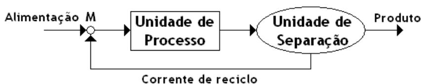
**Figura 20** Fluxograma típico de uma operação de reciclo.
