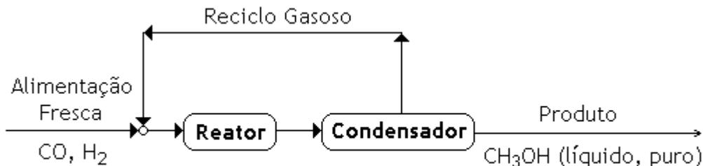
Figura 32 Fluxograma do processo de produção de metanol.
