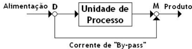
**Figura 19** Fluxograma típico de uma operação de *by-pass*.
