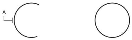
Figura 44 Convertendo arco em círculo.
