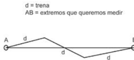
Figura 16 Definição do alinhamento entre dois pontos do terreno.
