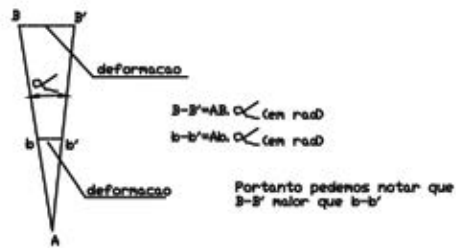
Figura 40 Deformação angular mínima na poligonal.
