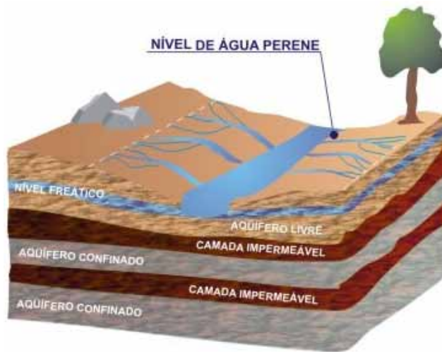
Figura 2.8 Esquema de aquíferos (BOSCARDIN BORGHETTI et al., 2004). Disponível em: < www.sacrahome.com.br/.../aguas-subterraneas >. Acesso em: 11 mar. 2009
