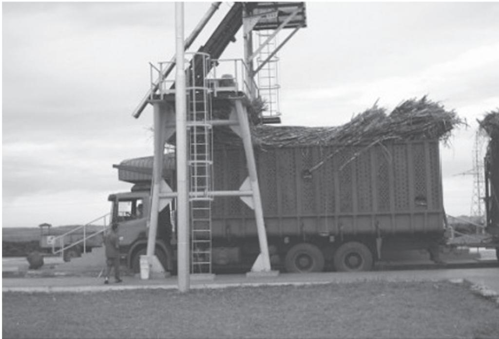
**Figura 2.5** Sonda oblíqua para amostragem de cana.
