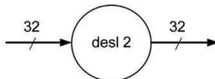
**Figura 73** Circuito de deslocamento de 2 bits à esquerda.
