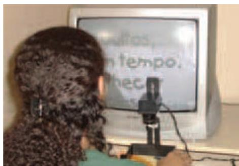
**Figura 13.** Circuito fechado de televisão – CCTV: aparelho acoplado a um monitor de TV monocromático ou colorido que amplia até 60 vezes as imagens e as transfere para o monitor.
